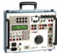
בדיקת ממסרים חד פאזי SVERKER 750 – SINGLE PHASE RELAY TESTING
